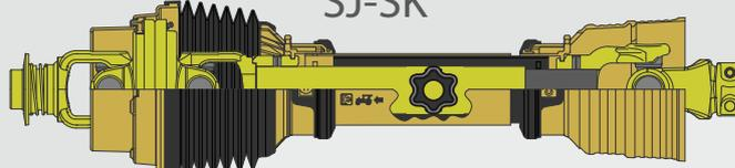
Le trasmissioni grandangolari SJ e SK (con tubi telescopici a profilo stellare) sono caratterizzate dalla presenza di un nuovo giunto omocinetico (che consente di lavorare con angoli di trasmissione fino a 80°) completamente ridisegnato, che può essere posizionato dal lato trattore (SJ) o dal lato attrezzo (SK).
