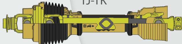
Le trasmissioni grandangolari TJ e TK (con tubi telescopici a profilo a limone) sono caratterizzate dalla presenza di un nuovo giunto omocinetico (che consente di lavorare con angoli di trasmissione fino a 80°) completamente ridisegnato, che può essere posizionato dal lato trattore (TJ) o dal lato attrezzo (TK).
