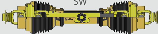
La trasmissione SW (con tubi telescopici a profilo stellare) è la risposta alle esigenze di massimizzazione degli angoli di lavoro, essendo caratterizzata dalla presenza del giunto omocinetico su entrambi i lati.
