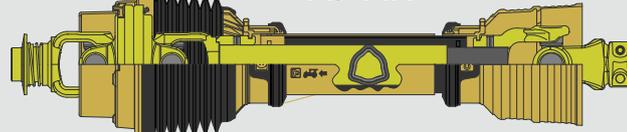
Le trasmissioni grandangolari AJ e AK (con tubi telescopici a profilo triangolare) sono caratterizzate dalla presenza di un nuovo giunto omocinetico (che consente di lavorare con angoli di trasmissione fino a 80°) completamente ridisegnato, che può essere posizionato dal lato trattore (AJ) o dal lato attrezzo (AK).
